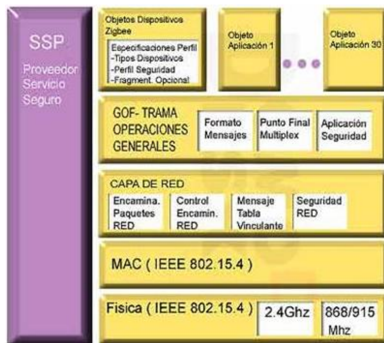
Figura 1.12. Diferentes capas que conforman la arquitectura ZigBee. 11
