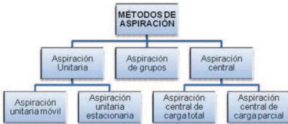
Figura 2.3. Métodos de aspiración de desperdicios 7
