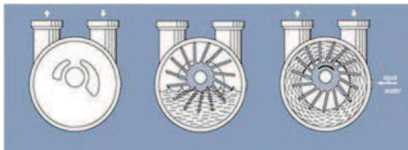
Figura. 2.7 Funcionamiento de una bomba de vacío. 9
