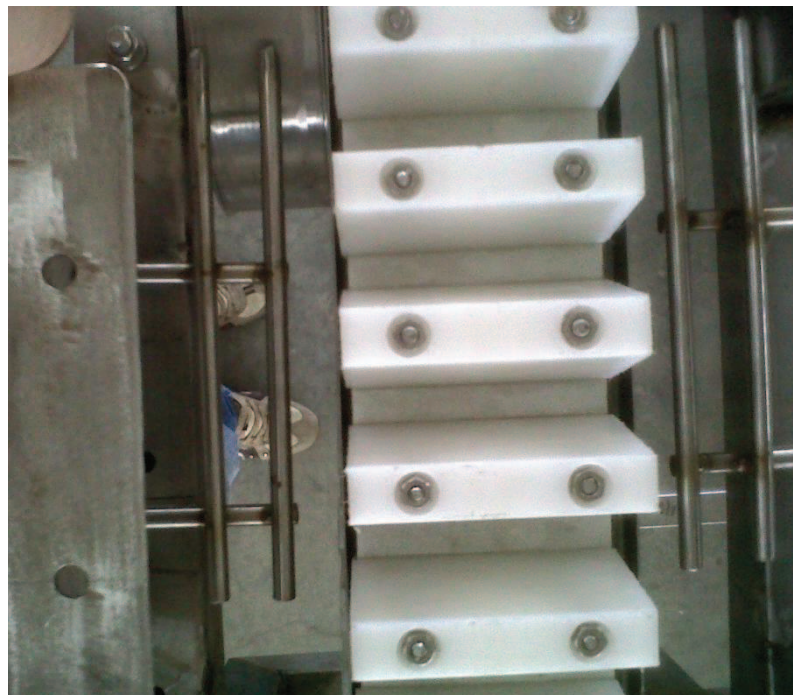
Figura 5.2 Varillas de soporte para la cabeza y para la cola en el corte. 80
