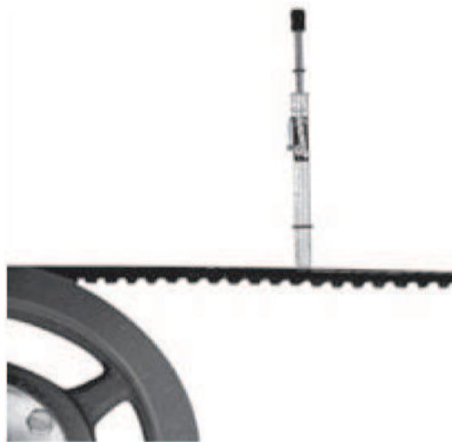
Figura 2.17. Verificador de tensión 14
