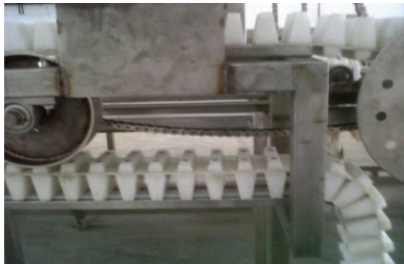
Figura 4.12 Máquina en etapa de desarme para limpiar soldaduras y pulir. 78
