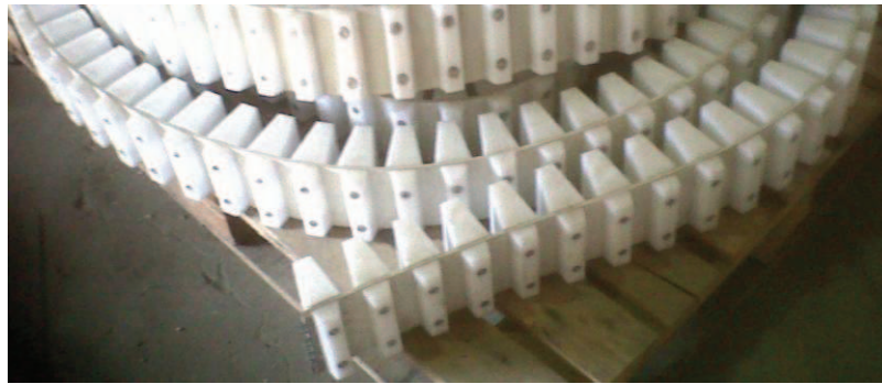
Figura 4.5 Banda ensamblada de trapecios extruidos y banda plana. 71
