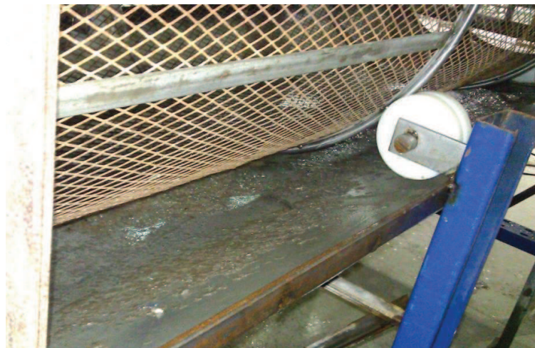
Figura 4.3b Utilización de poleas y tapas elaboradas en nylon-escamadora. 68
