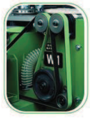
Figura 2.27. Disposición para invertir giro en una polea 15
