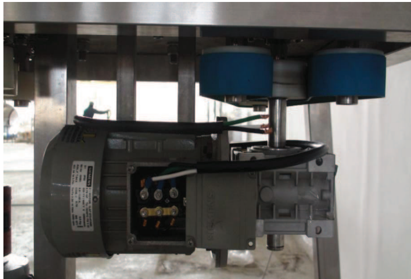
Figura 4.4 Utilización de motores marca Siemens en la cortadora de panza. 69
