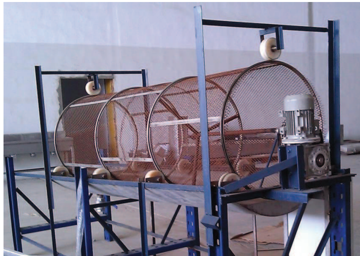
Figura 4.11 Ubicación del motor en la escamadora previo a realizar pruebas. 77
