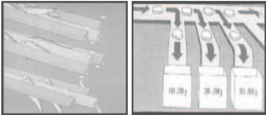
Figura 2.37 Métodos de clasificación de pescados: a) por grosor del pescado. b) por peso del pescado 27
