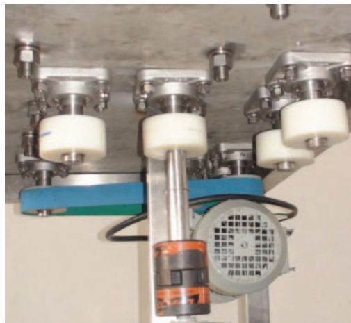
Figura 4.8 Ubicación de eje, poleas y bandas de transmisión en la cortadora de panza. 74
