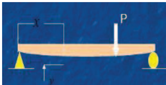
Figura 2.33b Deformación en viga antes y después de aplicada la carga 20
