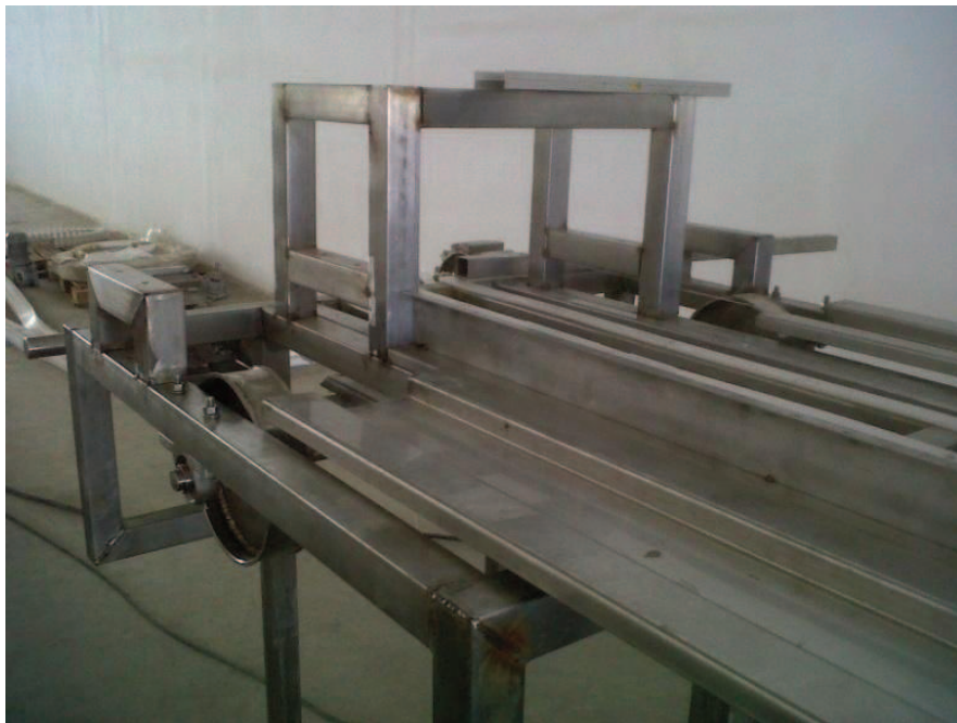
Figura 4.2 Plancha doblada montada sobre estructura de acero inoxidable. 66
