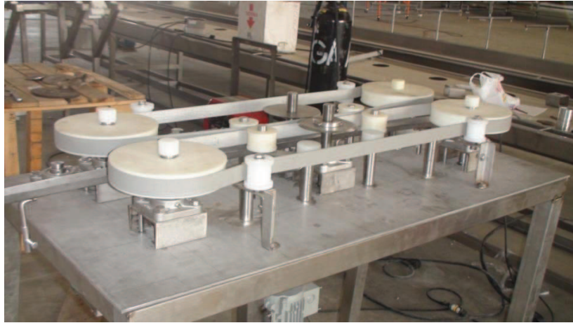
Figura 4.3a Utilización de poleas y tapas elaboradas en nylon-cortadora de panza. 67
