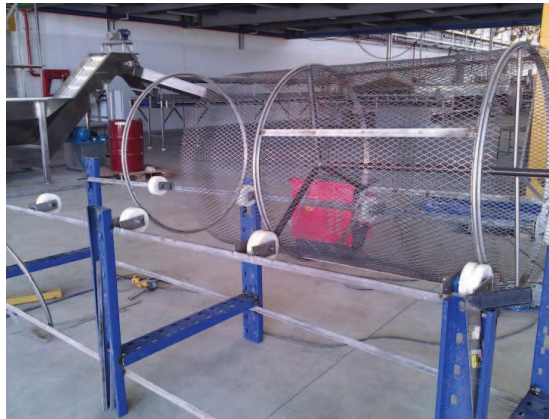
Figura 4.9 Ensamblaje de mallas y anillos guías sobre las poleas. 75
