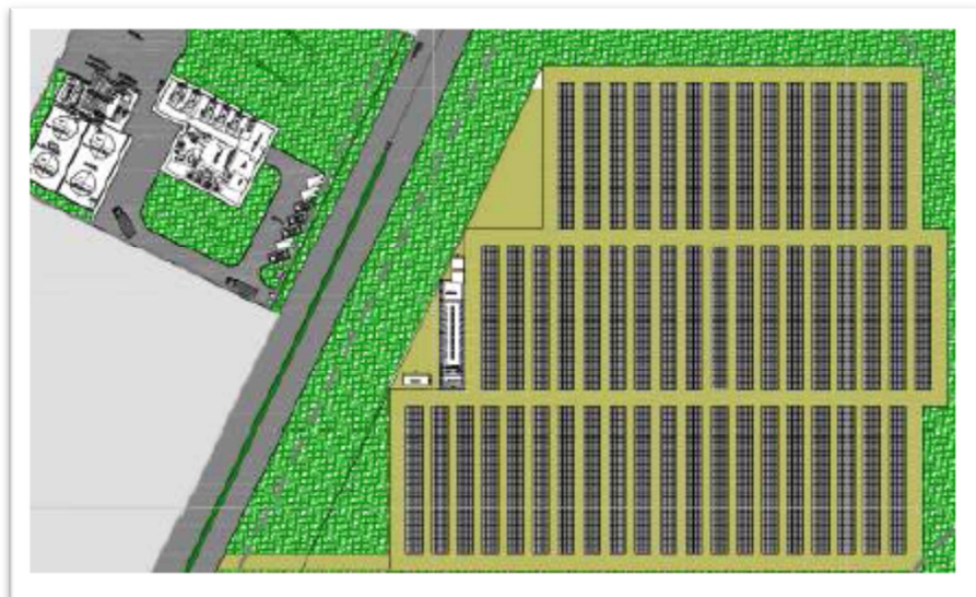
Gráfico 41 Diseño preliminar del sistema centralizado
