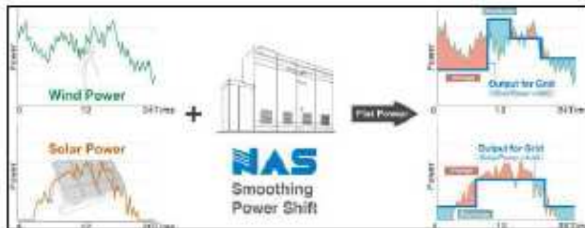
Gráfico 43 Efecto de uso de baterías industriales en la estabilidad eléctrica
