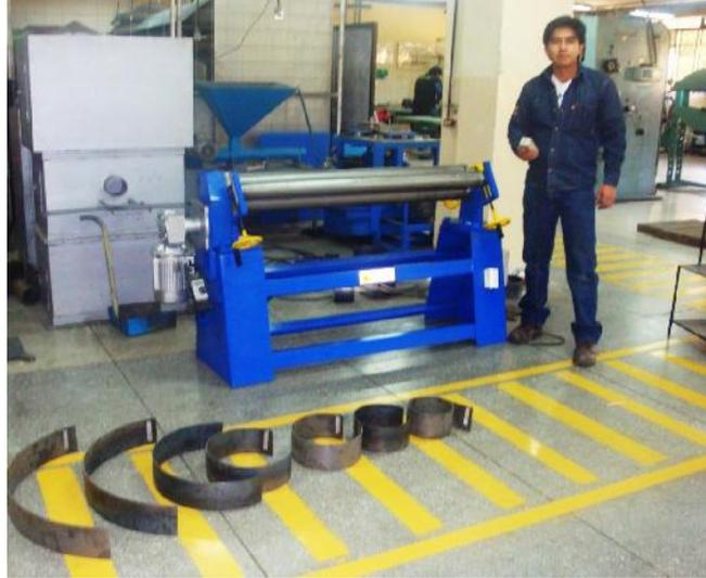
Para el barolado de láminas de acero A 36 de 3 mm de espesor se obtuvo un error de 5,29 % entre los valores obtenidos en prueba y los valores obtenidos con el modelo teórico.
