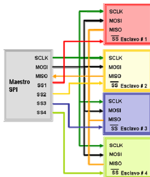
Figura 1.10: Conexión de varios dispositivos SPI.
