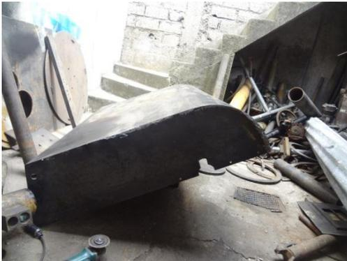
La tapa superior también completa con el diseño al retener la basura y hermetizar una vez con las partes principales listas procedemos a ensamblar.
