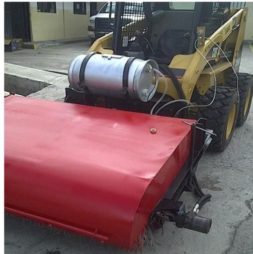
Tenemos sensores que nos indican altura y ángulo de el accesorio esta implementación es muy fundamental ya que en el caso de que el operario se encuentre solo es un poco difícil lograr la posición de barrido exacta por falta de visibilidad, estos sensores se activan, dando un sonido y una luz cuando se encuentren en posición de altura correcta y dos pitos y otro color
