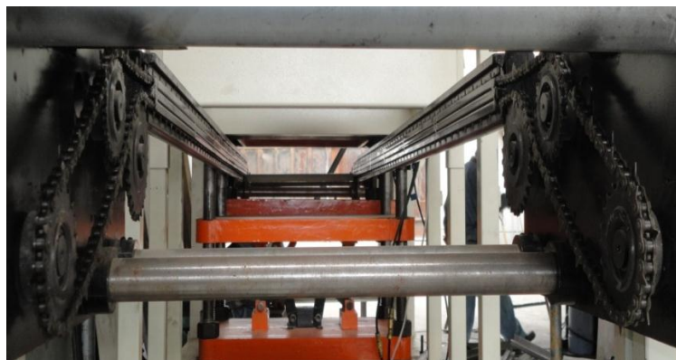
Figura 4. 5: Montaje de las ruedas dentadas y cadena de tracción.
