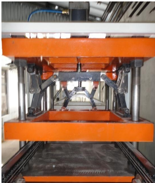
Figura 4. 3: Montaje del sistema de corte
