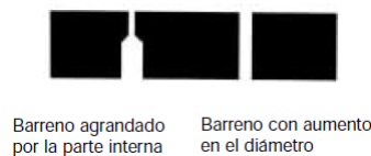
Figura 2. 13: Barrenos de la cámara de soplado.
