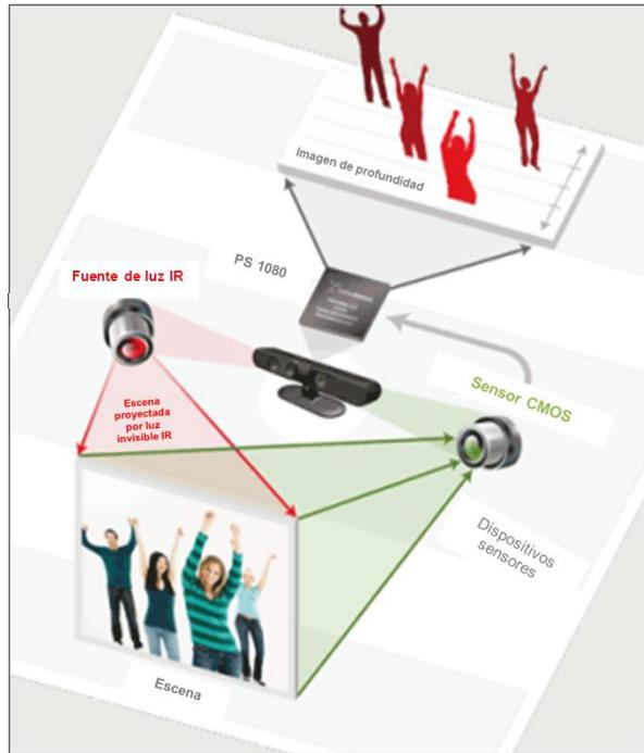
**Figura 1.14: Diagrama de la tecnología Kinect patentada por PrimeSense<sup>20</sup>**
