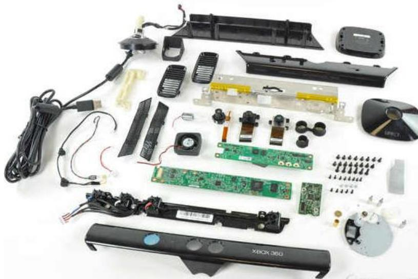
**Figura A.1: Kinect por dentro**
