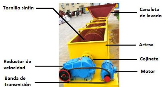
Figura 1: Esquema de la lavadora tipo tornillo
