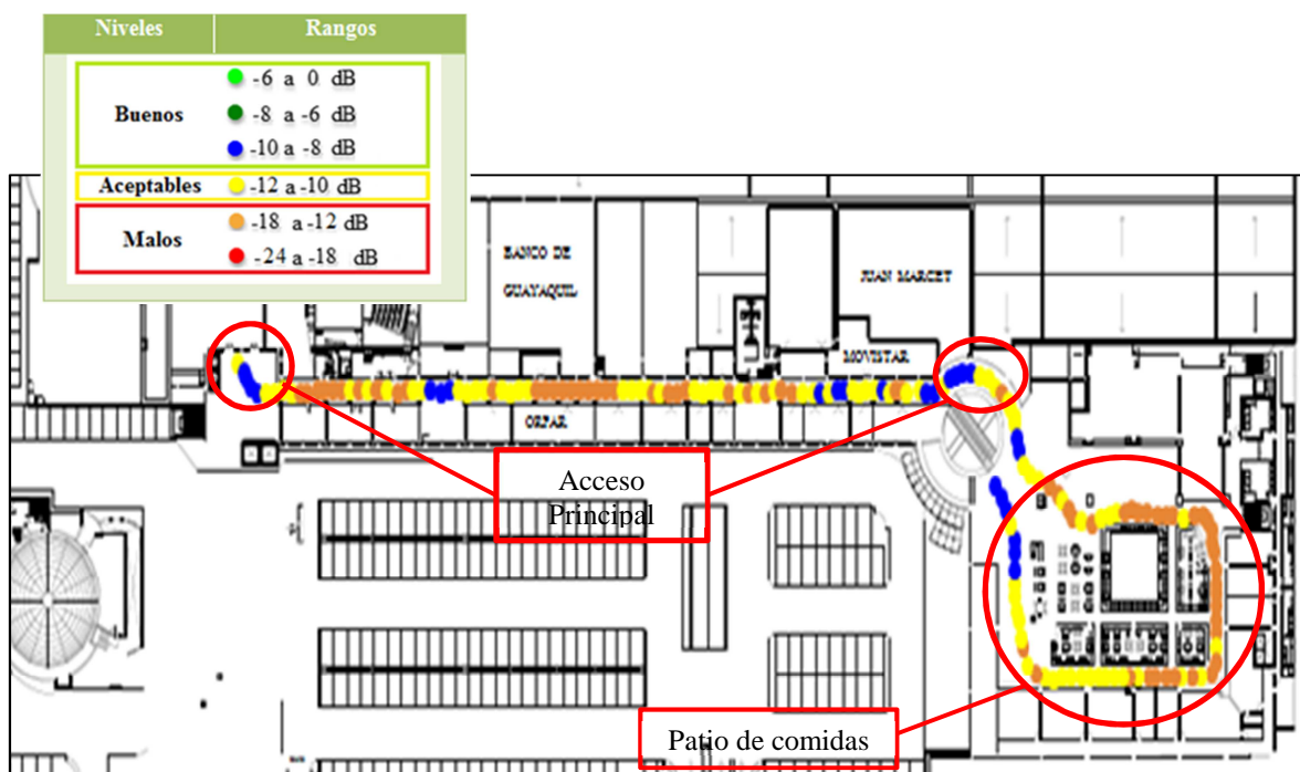
Figura. 4.15. Niveles de Ec/No del UE en modo Idle en día normal en el Piso 2.
