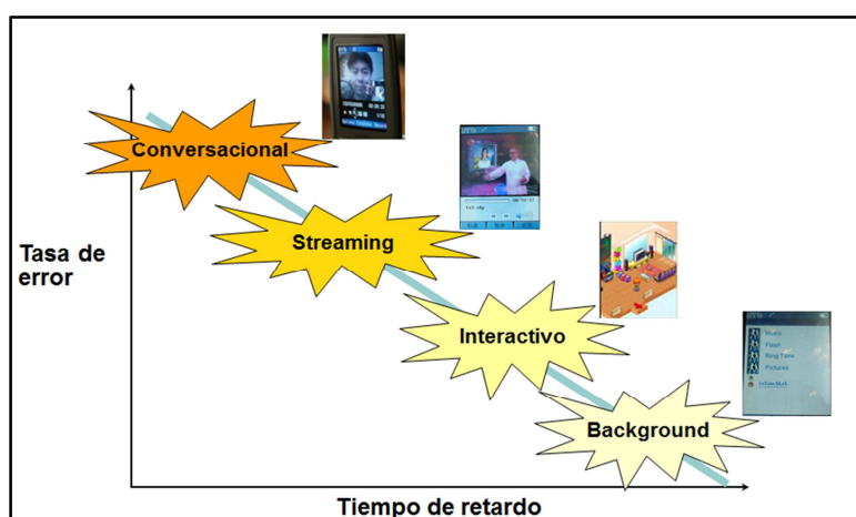
Figura. 2.14. Clases de QoS de UMTS en relación del retardo con la tasa de error
