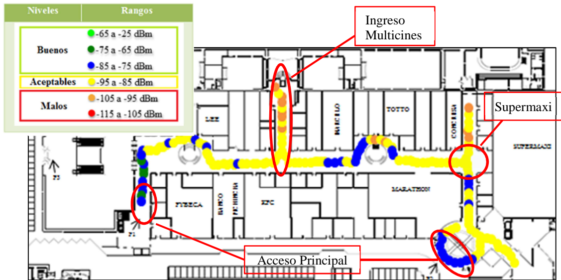
Figura. 4.9. Niveles de RSCP del UE en modo Idle en día normal en el Piso 1.
