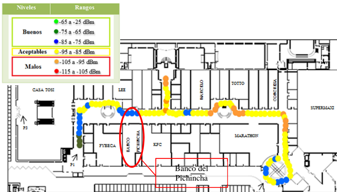
Figura. 4.13. Niveles de RSCP del UE en modo Idle en día atípico en el Piso 1.
