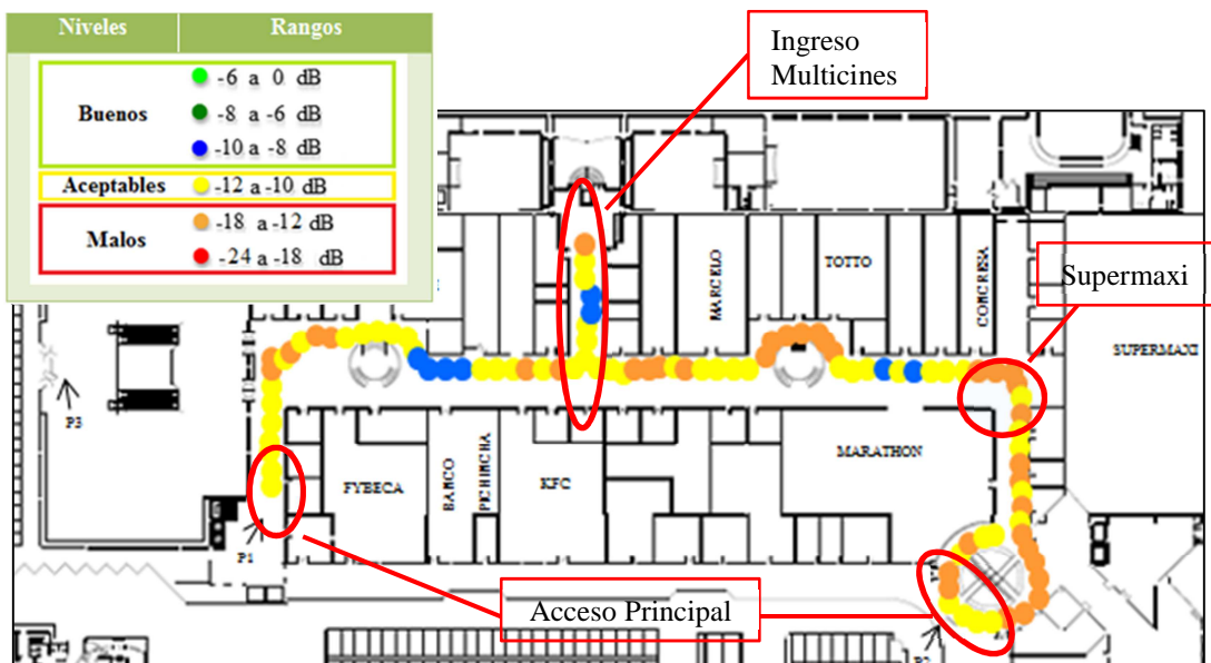
Figura. 4.12. Niveles de Ec/No del UE en modo Idle en día atípico en el Piso 1.
