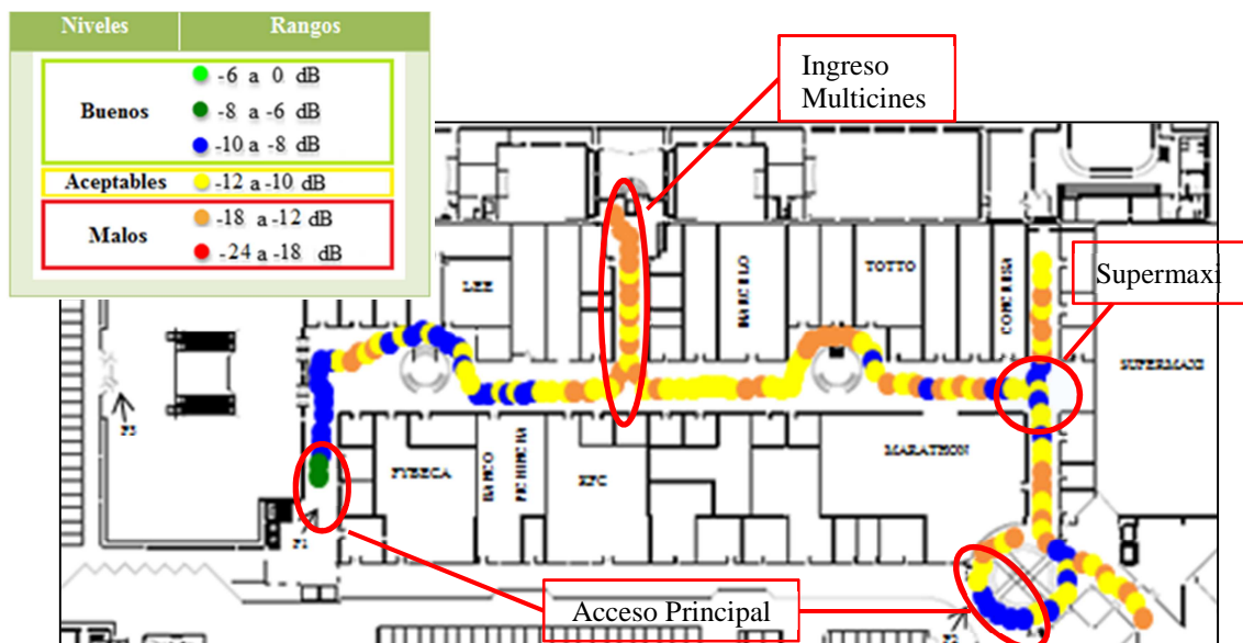
Figura. 4.10. Niveles de E_c/N_0 del UE en modo Idle en día normal en el Piso 1.
