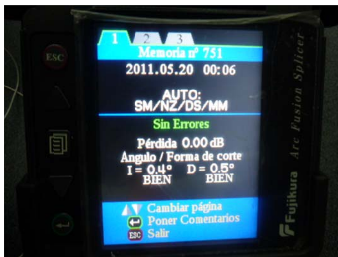
Figura. 2.26. Medición de fusionadora de FO obtenida luego de una fusión óptima
