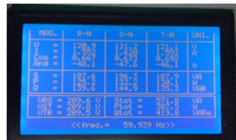
**Figura 1.5:** Visualización de datos mostrados en la pantalla LCD.
