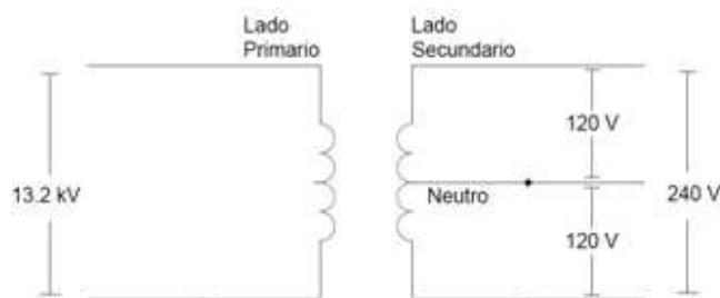
Figura 4.7. Conexión Monofásica primario 13200 – 220/127 V
