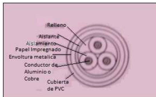
Figura 4.15. Estructura de conductor de medio voltaje
