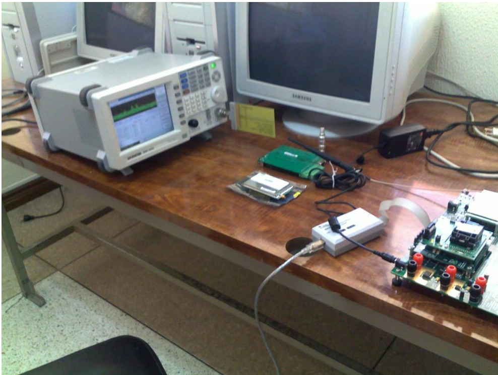
Fig. 6.8: Analizador de espectros capturando datos del CubeSat Kit.
