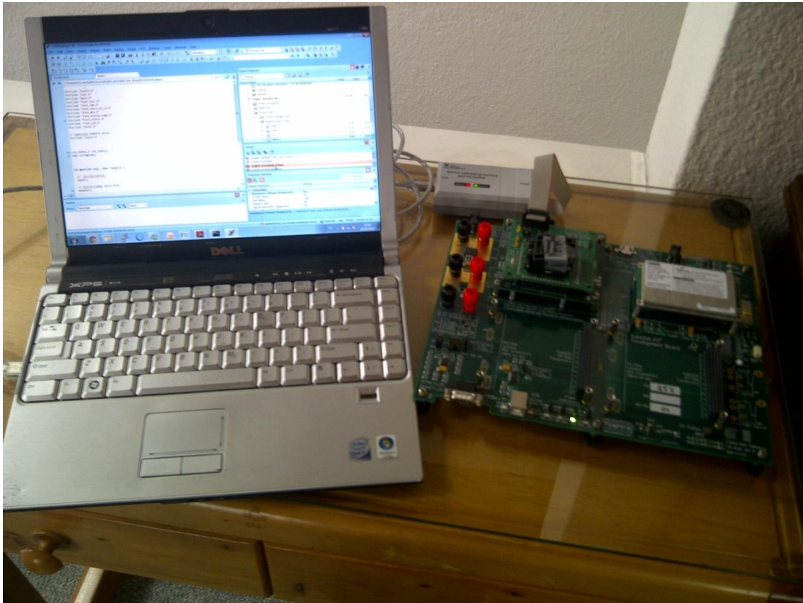
Fig. 5.2: Dispositivo JTAG conectado al Tablero de Desarrollo y a la computadora mediante el Ambiente de Desarrollo CrossWorks
