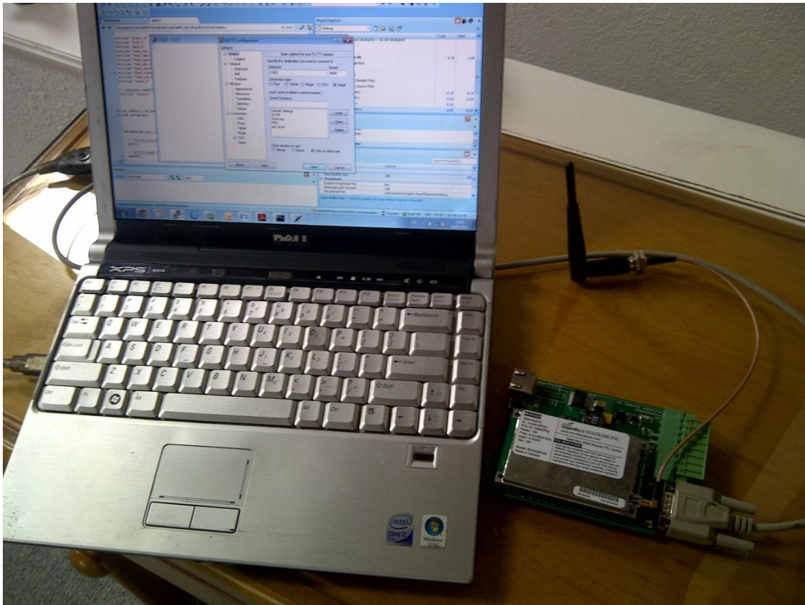
Fig. 3.9: Tablero de Desarrollo Microhard Corp. conectado a una computadora.
