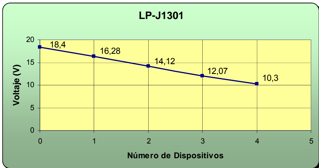
Figura 4. 18. Voltaje del Bus de acuerdo al número de dispositivos conectados
