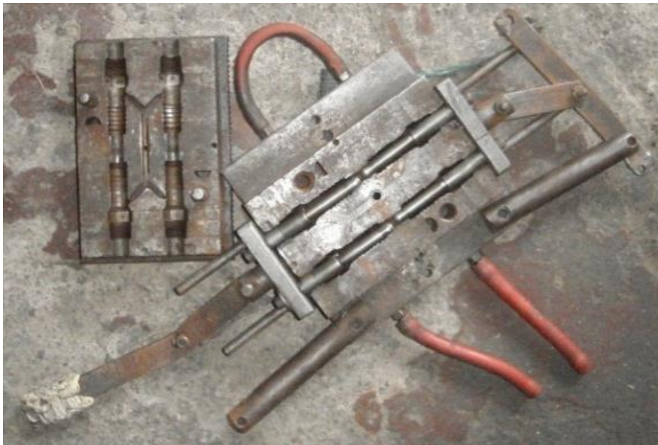
Figura 1.4. Desensamblaje de machos en placa fija.
