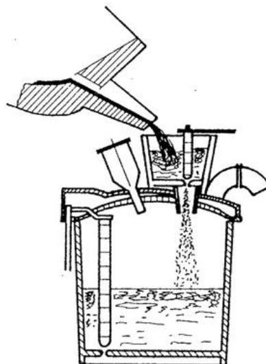
Figura 2.102 Sistema de desgasificación en vacío 95 .
