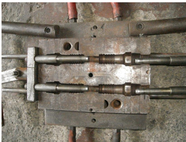
Figura 1.6. Desensamblaje de machos en placa fija.
