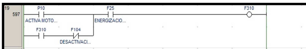
Figura 4. 130: Re-activación Motor 1 Barco 1 Mando Automático (Fuente Propia, 2012).
