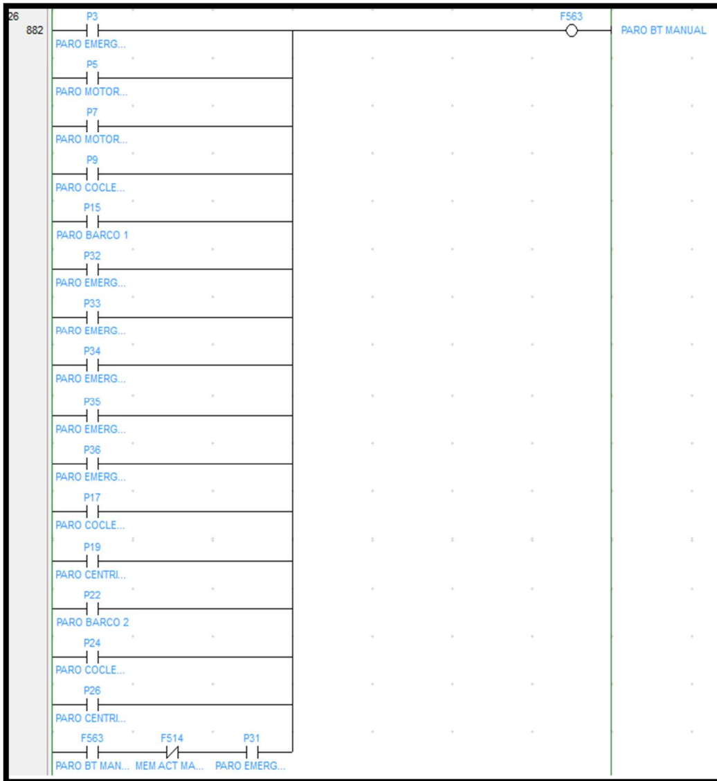
Figura 4. 165: Paro Banda Transportadora Mando Manual (Fuente Propia, 2012).
