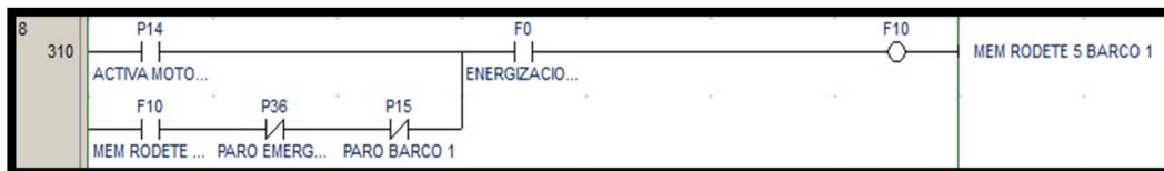
Figura 4. 89: Activación Motor 5 Barco 1 Mando Mantenimiento (Fuente Propia, 2012).
