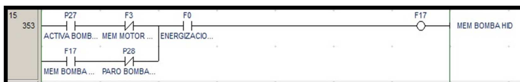
Figura 4. 96: Activación Bomba Hidráulica Mando Mantenimiento (Fuente Propia, 2012).
