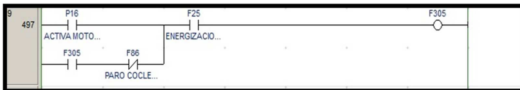
Figura 4. 120: Re-activación Cóclea 2 Mando Automático (Fuente Propia, 2012).
