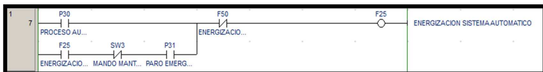
Figura 4. 26: Energización Mando Automático (Fuente Propia, 2012).
