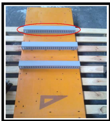
Figura 5. 2: Canaletas (Fuente Propia, 2012).
