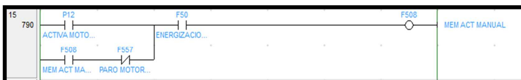
Figura 4. 154: Re-activación Motor 3 Barco 1 Mando Manual (Fuente Propia, 2012).
