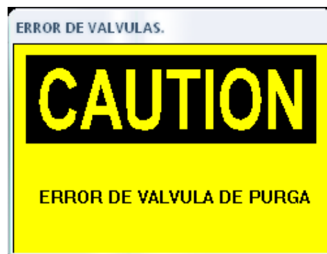
Figura 10 Falla en Válvula de Purga.
