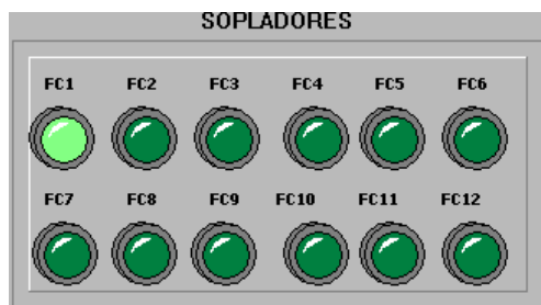
Figura 22 Soplador uno en funcionamiento.
