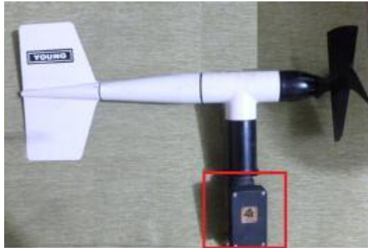
Figura 2.27: Ubicación del serial del monitor de viento 05103 RM YOUNG.
