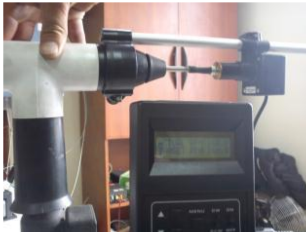
Figura 2.29: Calibración del monitor de viento 05103 RM YOUNG.
