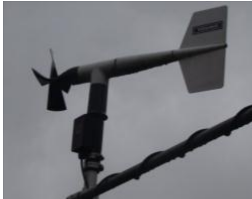
Figura 2.25: Estado en el que se encontró el monitor de viento 05103 RM YOUNG.
