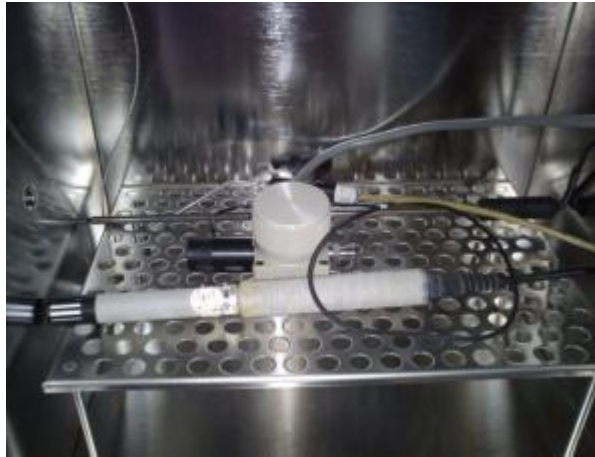
Figura 2.10: Sonda HMP45C VAISALA con sensores patrón de temperatura y humedad relativa en el interior del banco de calibración.
