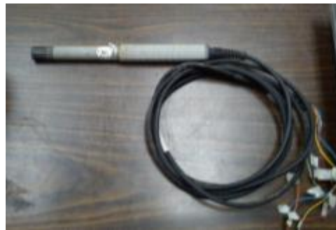
Figura 2.6: Sonda de Temperatura y Humedad Relativa previo a la limpieza.
