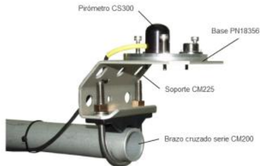
Figura 2.33: Montaje de pirómetro con soporte CM225. [60]
