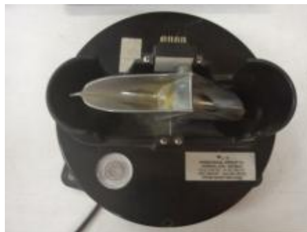
Figura 2.17: Estado en que se encontró el pluviómetro.
