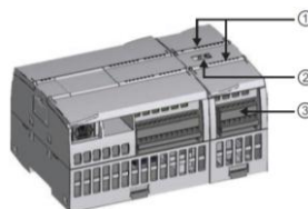
Figura 2c.- figura de módulo de señales
