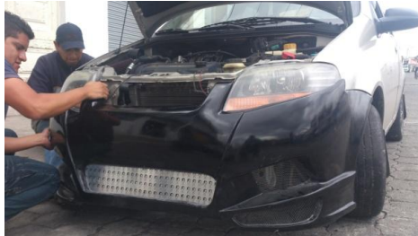
Figura 13. Instalación Faldón Delantero
