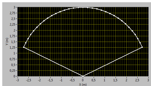
Figura 4. 4: Cobertura de medición del sensor ultrasónico puesto en el autómata
