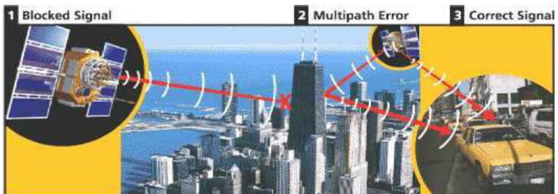
Figura 1.34: Errores de GPS que muestran una señal bloqueada y una señal multi-camino
