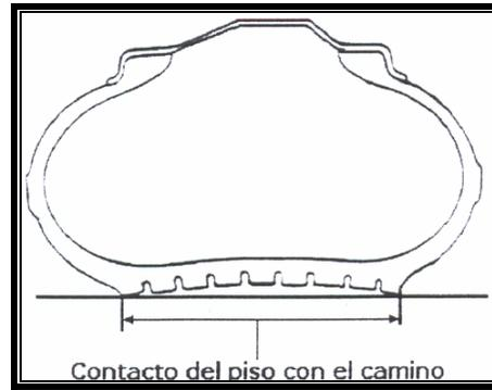
Figura. 2.8. Neumático inflado en defecto o subinflado
