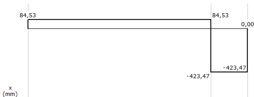
Figura 2.12: Fuerzas cortantes generadas
