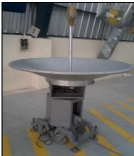
Figura 2. 25 Estructura del apuntador de antenas construido
