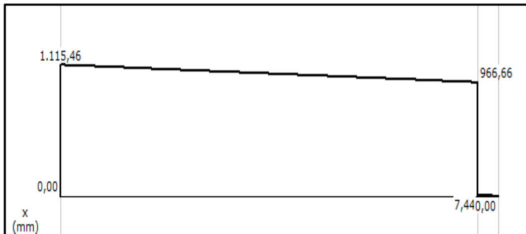
Figura 2. 10 Diagrama de fuerzas cortantes del árbol
