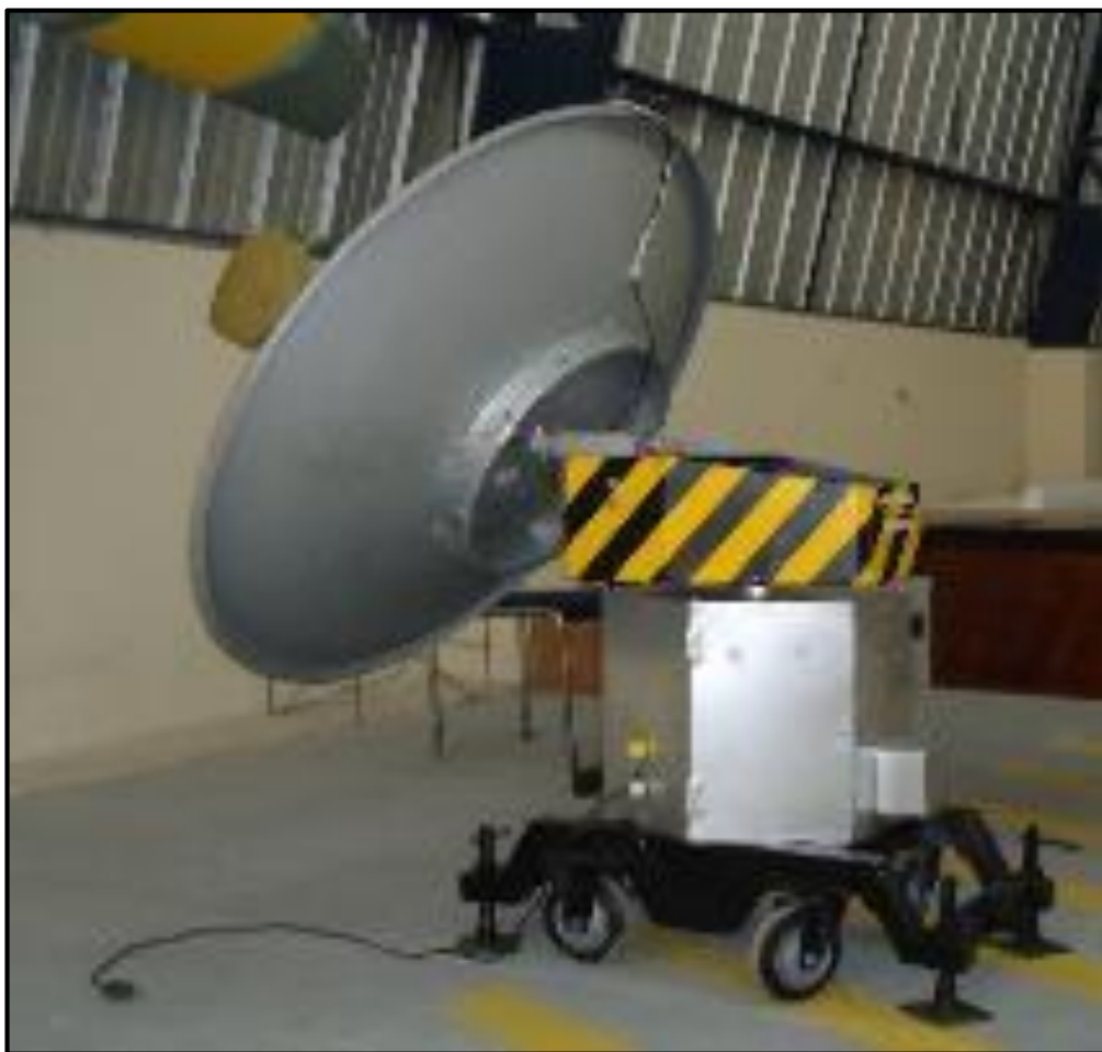
Figura 3. 12 Apuntador Electromecánico de Antenas
