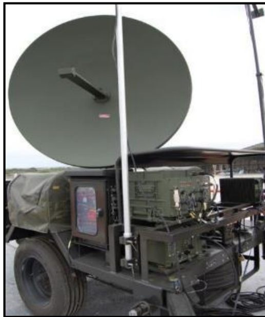
Figura 1. 3 Sistema de apuntamiento de antenas en Manta.
