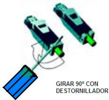
Figura 2.7. Cable Conector IE Fast Connect atornillado y listo para usarse
