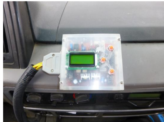
Figura 11.- Montaje final del dispositivo
