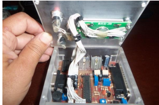
Figura 7.- Montaje de los elementos electrónicos
