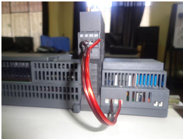
Figura 2.22. Conexión del modem SINAUT MD720-3 a la fuente.
