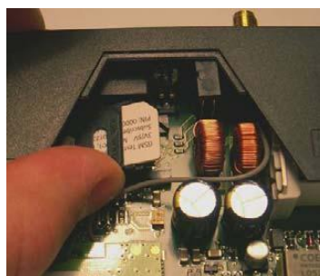
Figura 2.11 Introducción de la tarjeta SIM en el SINAUT MD720-3.
