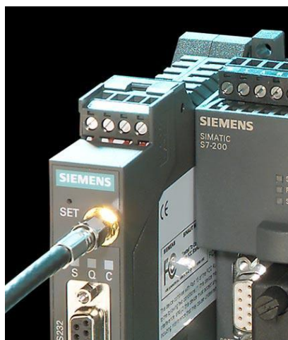
Figura 2.20. Conexión de la Antena ANT794-4MR con el módem MD720-3.
