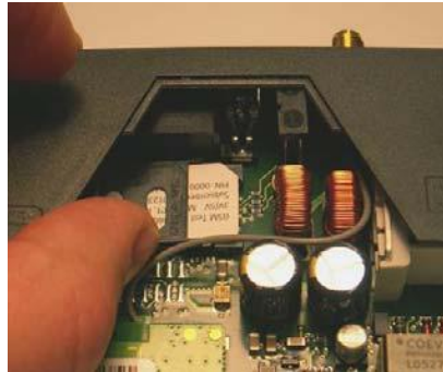
Figura 2.12 Introducción de la tarjeta SIM en el SINAUT MD720-3.
