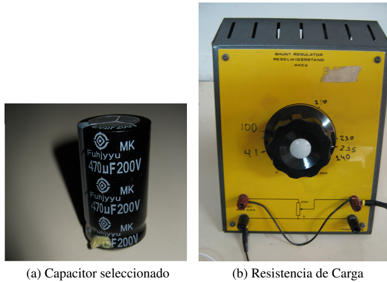
Figura 4.14: Componentes principales del convertidor Buck-Boost
