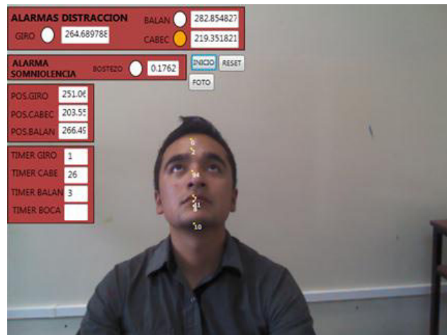
Figura 4.31 Alarma de cabeceo encendida, arriba
