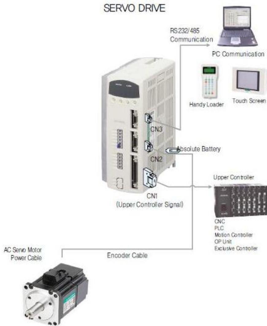
**Figura 5.25: Conexión Servo Drive <sup>55</sup>**
