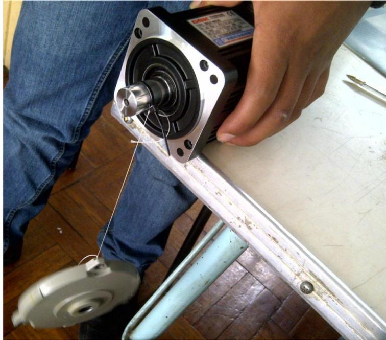
**Figura 4.56: Obtención del torque de fricción (experimental)**
