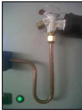
**FIGURA 3.6: VÁLVULA DE EXPANSIÓN Y TRAMPA DE ACEITE**
