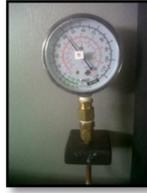
**FIGURA 3.14: MANÓMETRO DE BAJA**
