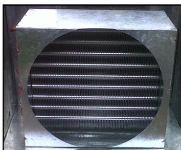
**FIGURA 3.12: CONDENSADOR EN SECADOR**
