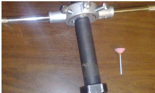
**Figura 4.5.** *Proceso de roscado con el portamachos.*
