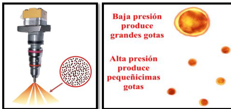
Figura 2: Mejor atomización del combustible.
