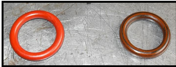
Figura 188: Comparación de un o-ring en buen y mal estado.
