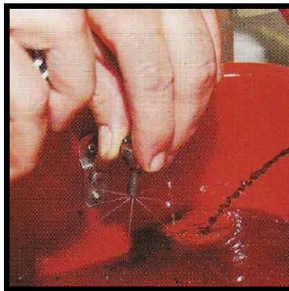
Figura 190: Verificación de la tobera y válvula de aguja.
