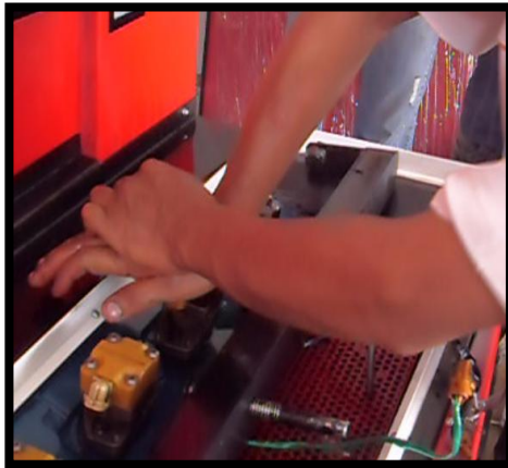
Figura 7: Fijación del inyector sobre su asiento en la matriz.
