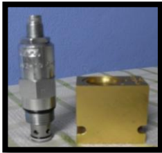
Figura 5: Válvula de alivio RV3 y housing para la aplicación.
