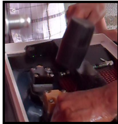
Figura 7: Fijación del inyector sobre su asiento en la matriz.
