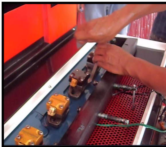
Figura 10: Desmontaje del inyector de la matriz.
