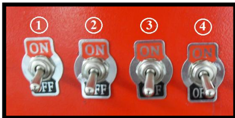
Figura 21: Conjunto de conmutadores en la señal de cada bobina del inyector.
