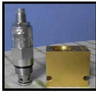
Figura 68: Válvula de alivio RV3 y housing para la aplicación.
