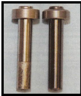
Figura 185: Comparación del plunger en buen y mal estado.
