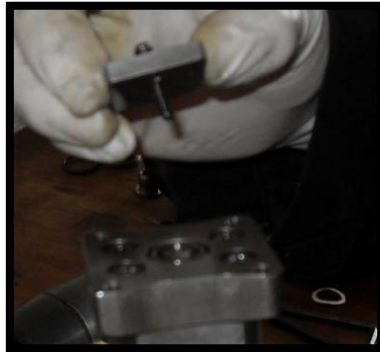
Figura 178: Montaje de la armadura sobre el espaciador.
