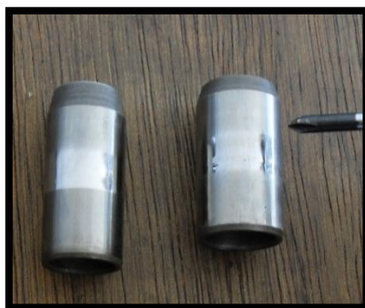
Figura 186: Pistón intensificador con superficie irregular.
