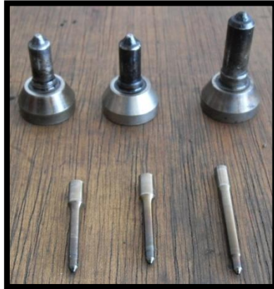
Figura 191: Válvula de aguja desgastada.
