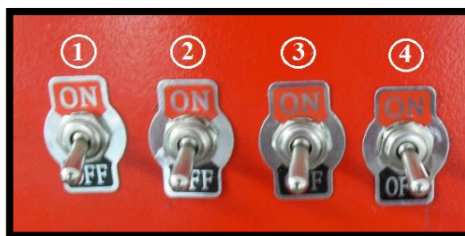
Figura 13: Conjunto de conmutadores en la señal de cada bobina del inyector.
