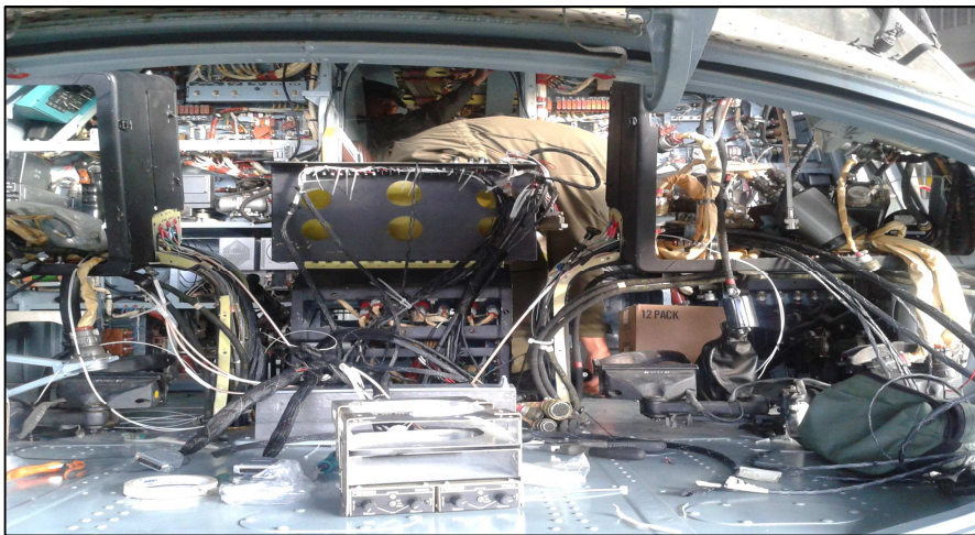
Figura 57 Desmontaje de instrumentos cabina
