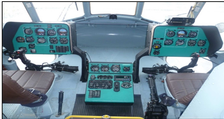
Figura 15 Configuración original de los Paneles de instrumentos
