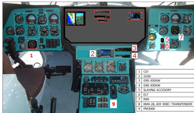
Figura 42 Cabina bajo recomendación de fabrica
