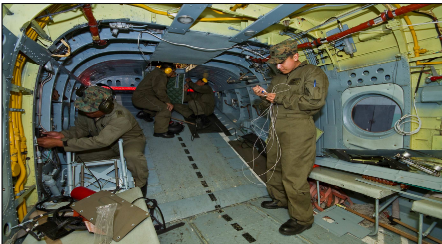
Figura 58 Instalación de cableados (Arneses)
