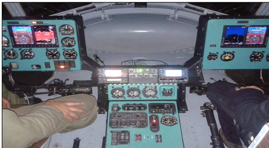
Figura 61 Sistema G500H Operando (M1 7171E Modernizado)
