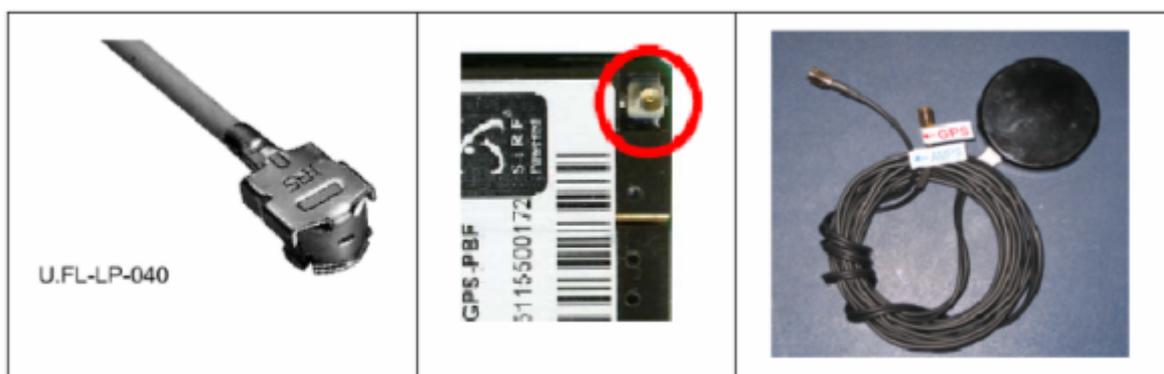
**Figura 2.12.** a) Conector U.FL hembra de la antena. b) Conector U.FL macho del módulo XT56.
