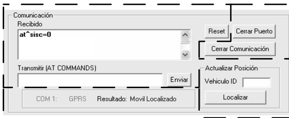
El segundo bloque está diseñado para que el programador pueda visualizar los eventos de enlace a la red, transmisión y recepción de tramas a través de comandos AT que es el lenguaje con el que se gestiona las comunicaciones con el módulo GPRS. Para ello se
