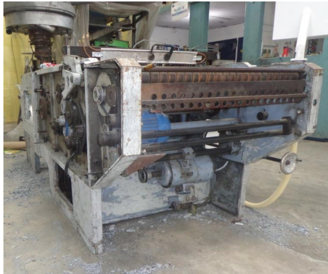
Figura2. 39: Desprendimiento de la pintura
