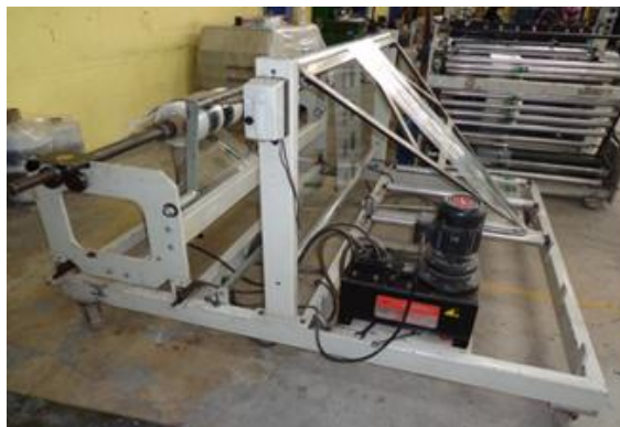
Figura2. 2: Alineación y Doblado del Rollo de Plástico
