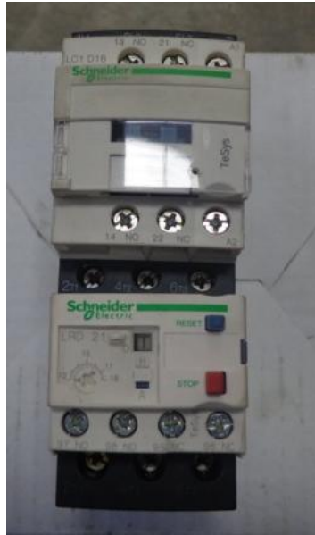
Figura2. 10: Contactor Marca Schneider
