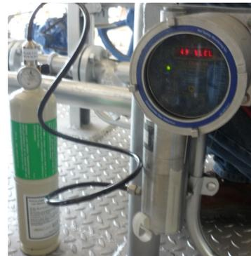
**Figura 9. Prueba de Detector de Gas**
