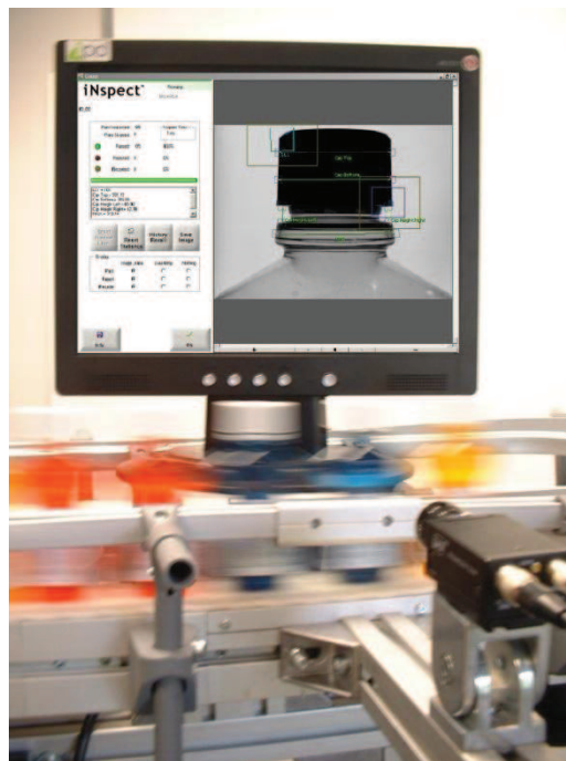
Figura 1.6 Inspección de nivel de líquido y sellado de botellas utilizando software de Visión Artificial 2
