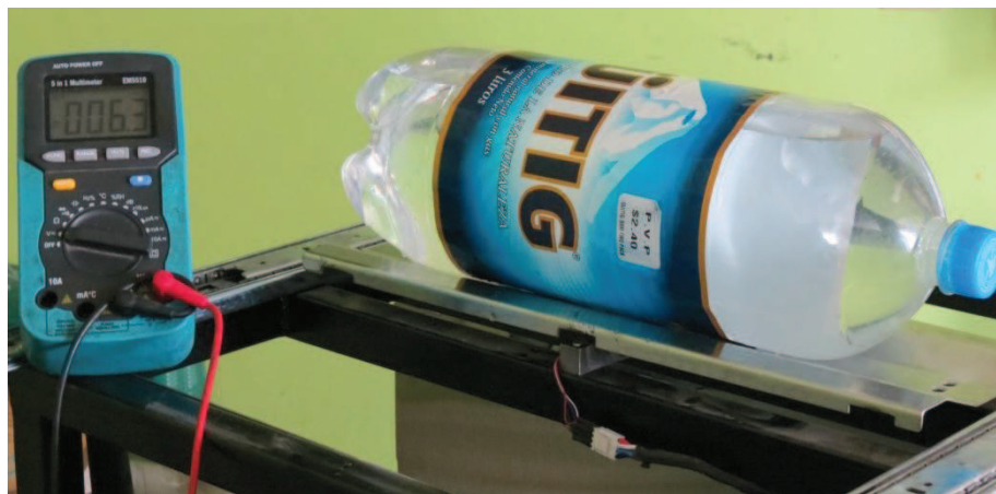
Figura 3.16 Medición de voltaje en terminales de salida del sensor piezoeléctrico sin acondicionamiento con una botella PET de 3000cm 3 llena de líquido.
