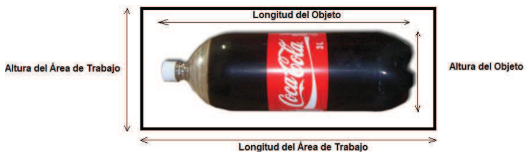
Figura 3.21 Dimensiones a considerar para el cálculo de la resolución
