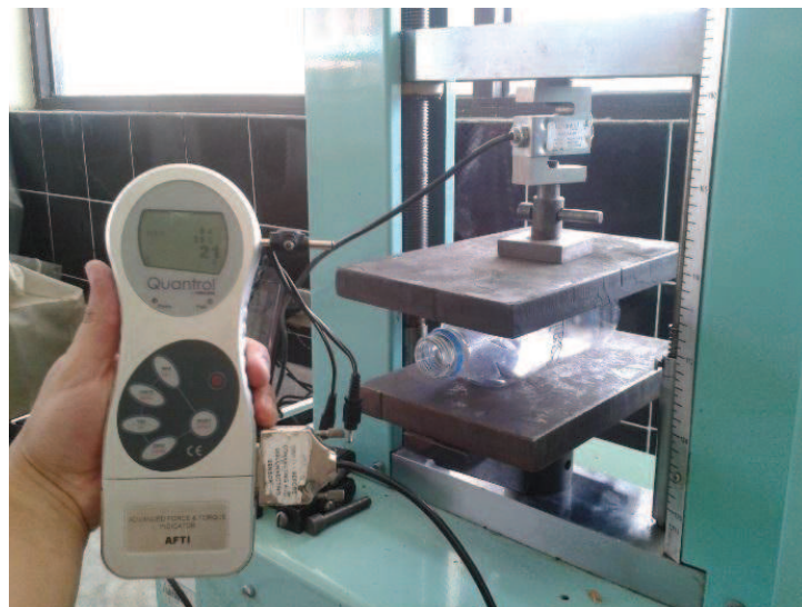
Figura 2.11 Ensayo de Compresión de botellas PET
