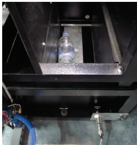
Figura 5.16 Botella aceptada y transportada a la cámara de aceptación
