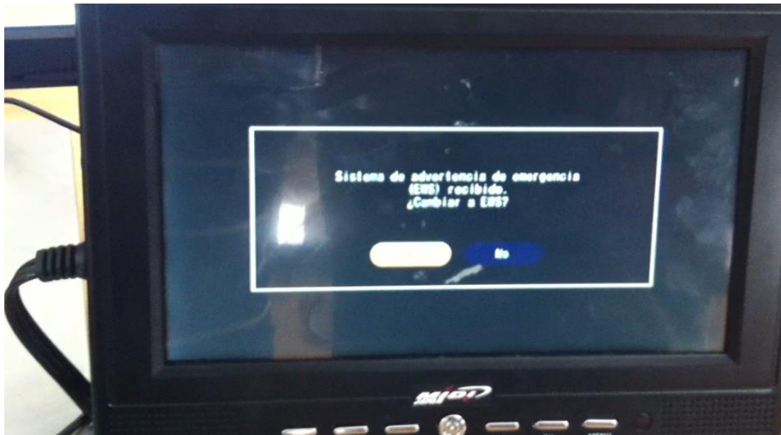
Figura 5.13: Recepción de la señal de emergencia configurado en un modo de programación diferente al mostrado en el receptor
