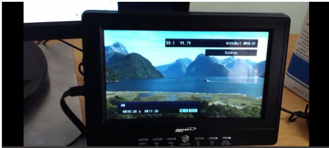
Figura 5.16a: Set-Top-Box, continúa mostrando la programación normal al detectar bandera de emergencia con código de área no configurado en él
