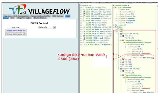
Figura 8. Muestra de la señal de emergencia activada mediante el uso del analizador de flujo de datos
