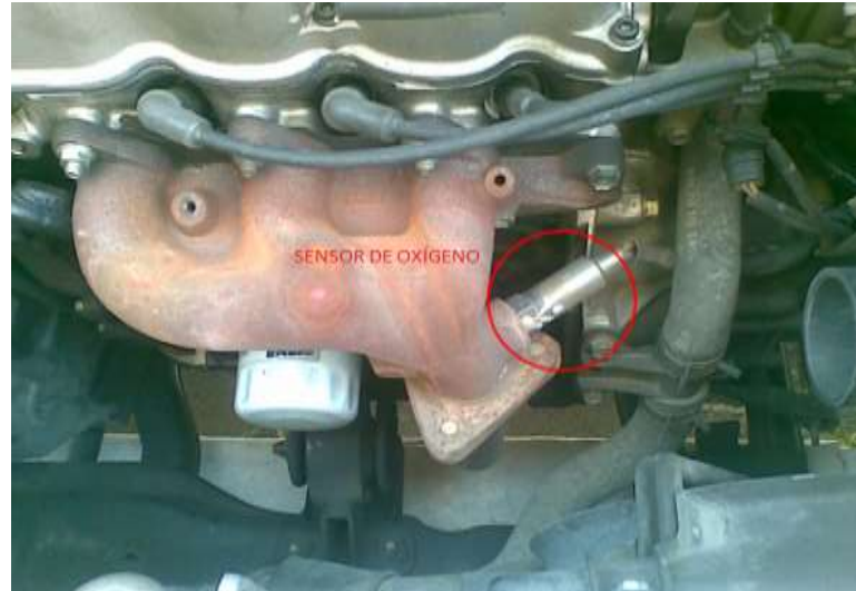
Figura 2.16: Ubicación del Sensor de oxígeno de zirconio en el flujo de los gases de escape.
