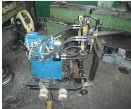
Figura 6 Montaje de la central hidráulica y válvulas al bastidor
