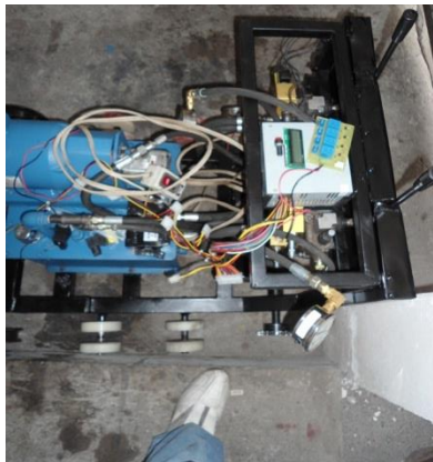
Figura 7 Montaje e instalación del circuito electrónico
