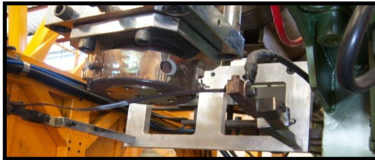
(a) Cabezal extrusor y cuchilla de la máquina sopladora de polietileno marca MagicMp.
