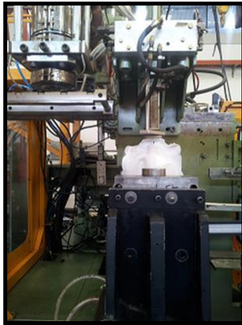
Figura 3. 6. Soplado del envase de galón.
