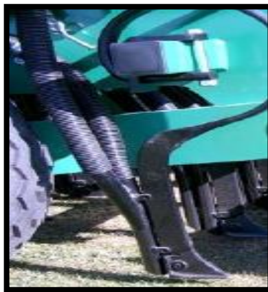
Figura. 2.8 Tubos de descarga
