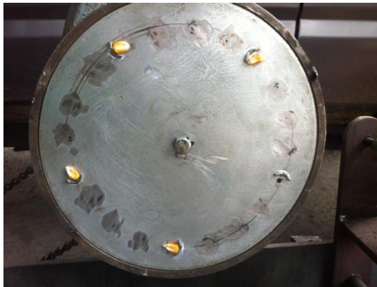
Figura. 5.1 Pruebas de funcionamiento del dosificador neumático
