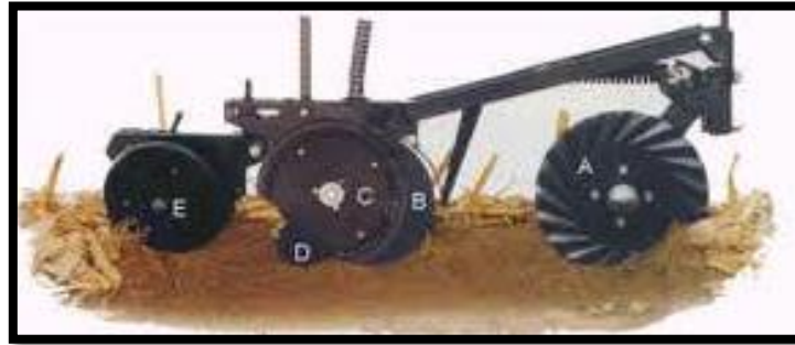
Figura. 2.17 Tren de siembra (E: Rueda compactadora)
