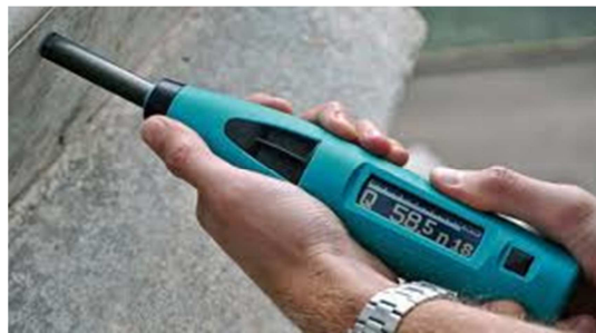
Figura 5.1: Estudio del concreto con esclerómetro
