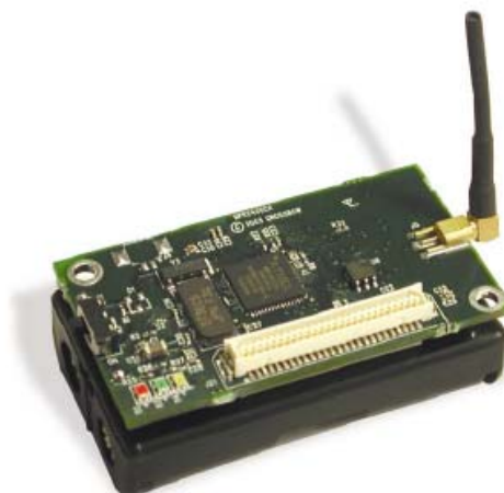
Figura 3. 1: Mote MPR2400, Sensor Inalámbrico con Antena Estándar
