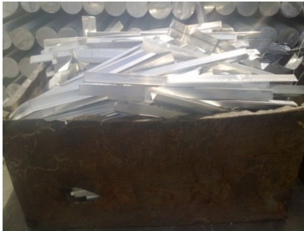
Figura 1.3 Materia prima para el horno de fundición Fuente: Investigación de campo Empresa CEDAL S.A
