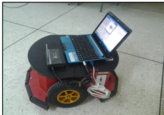
Figura. 3.8 Interfaz MATLAB-ARIA conectada con el robot físico
