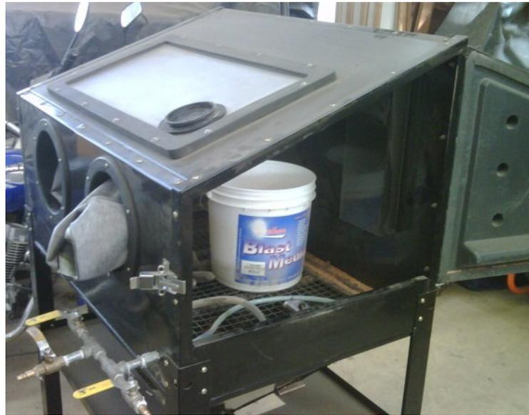
La reutilización de la cabina se logró modificando la estructura de la misma, realizando perforaciones en las paredes laterales, colocando membranas retractiles en los orificios para permitir el ingreso de la tubería a la cabina evitando la salida del abrasivo al medio ambiente.
