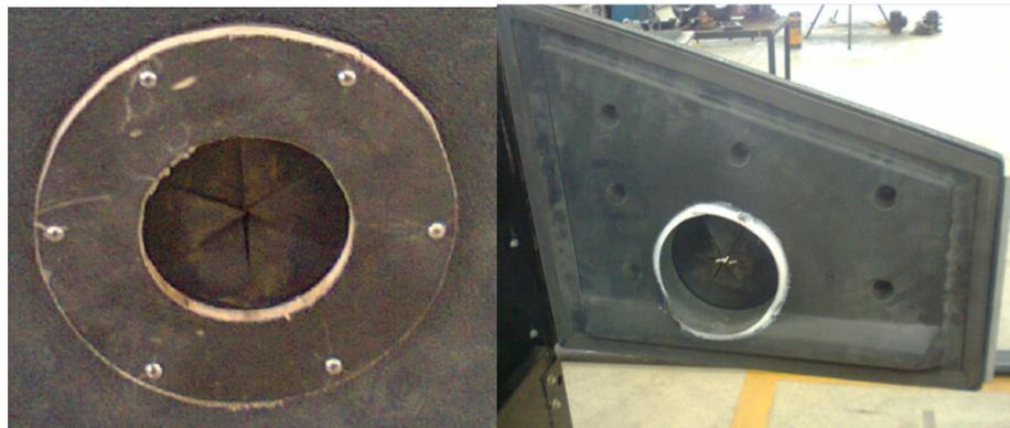
Por último se diseñaron y construyeron elementos de soporte para las tuberías que permiten un tránsito horizontal y rotacional de la tubería a través de la cabina de sandblasting para la limpieza de tuberías de hasta 4 pulgadas de diámetro y 6 metros de largo.
